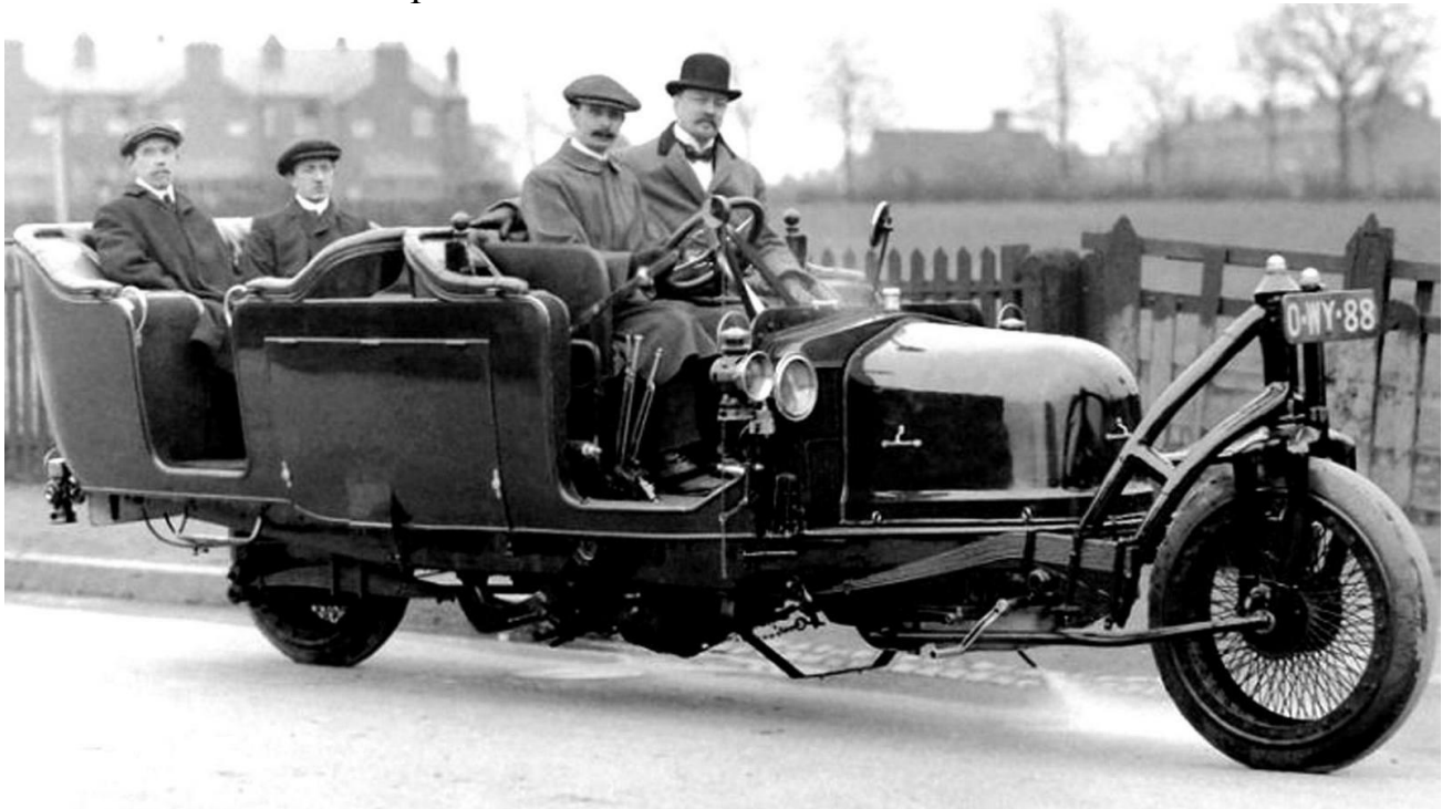
рис.2 Гироскопический автомобиль Петра Шиловского 1913г.
