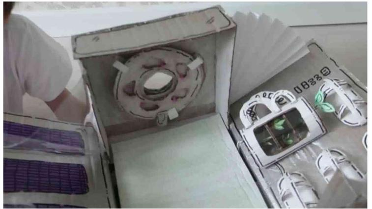
Далее был установлен микроконтроллер конструктора LEGO MINDSTORMS EV3, с помощью которого луноход будет приводиться в движение. За вращение бура и колес отвечает большой мотор, датчик цвета срабатывает на белый цвет, а средний мотор открывает диафрагму для переработки мусора.
