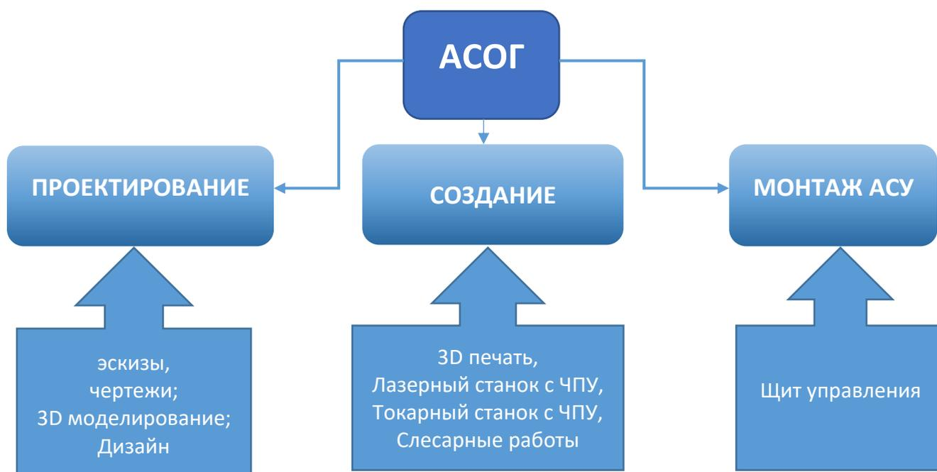
Схема 1 – Технологии, используемые в АСОГ
