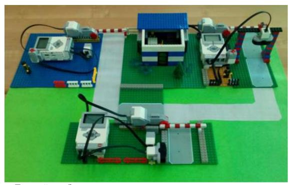
Первый робот пропускает машины на территорию, разводя транспортный поток по двум направлениям: вправо — грузовой автотранспорт, влево — легковой автотранспорт и автобусы.
