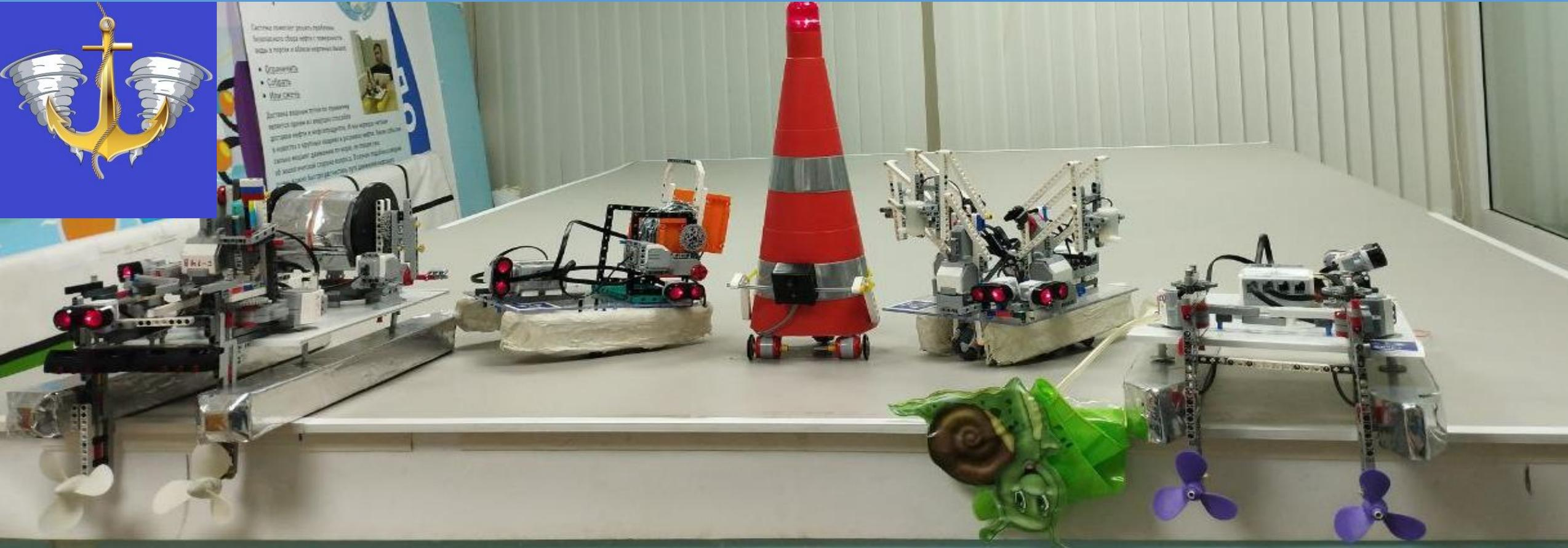
Комплекс состоит из робота Разведчика (с техническим зрением), Ограничителя и Сборщика пленки с поверхности воды. НАЙТИ, ОГРАНИЧИТЬ, СОБРАТЬ или СЖЕЧЬ.
