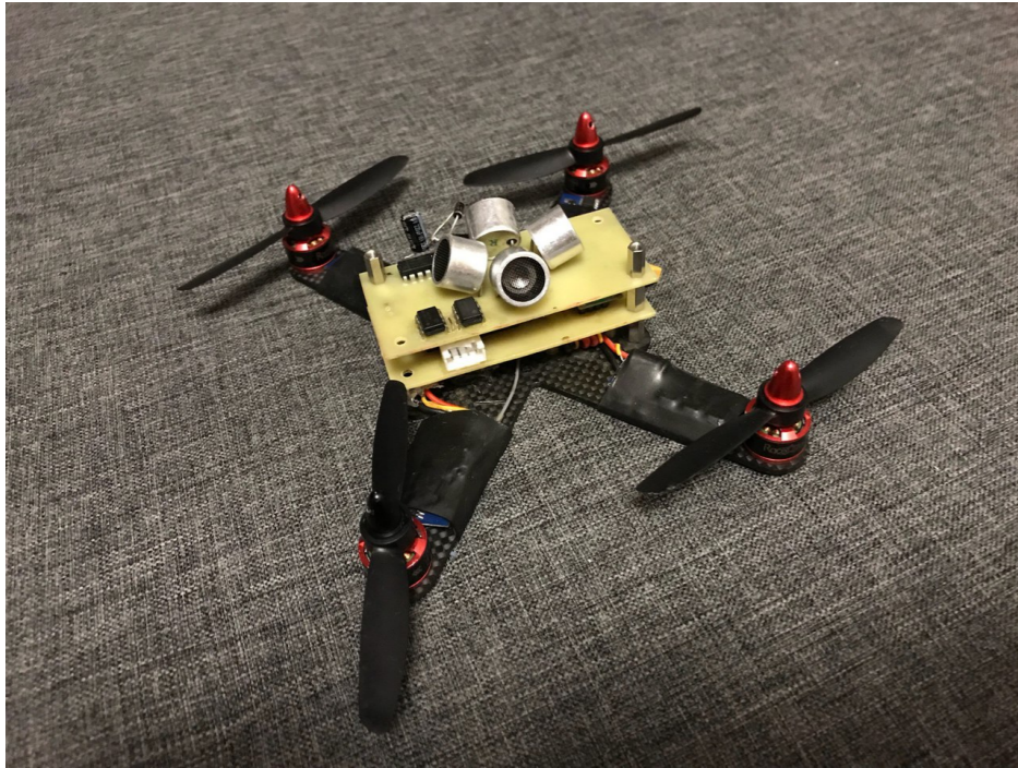
Мобильный маяк установленный на квадрокоптере
