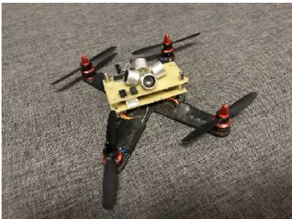
Мобильный маяк установленный на квадрокоптере
